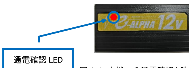
図 4-2 本機への通電確認と防水措置
